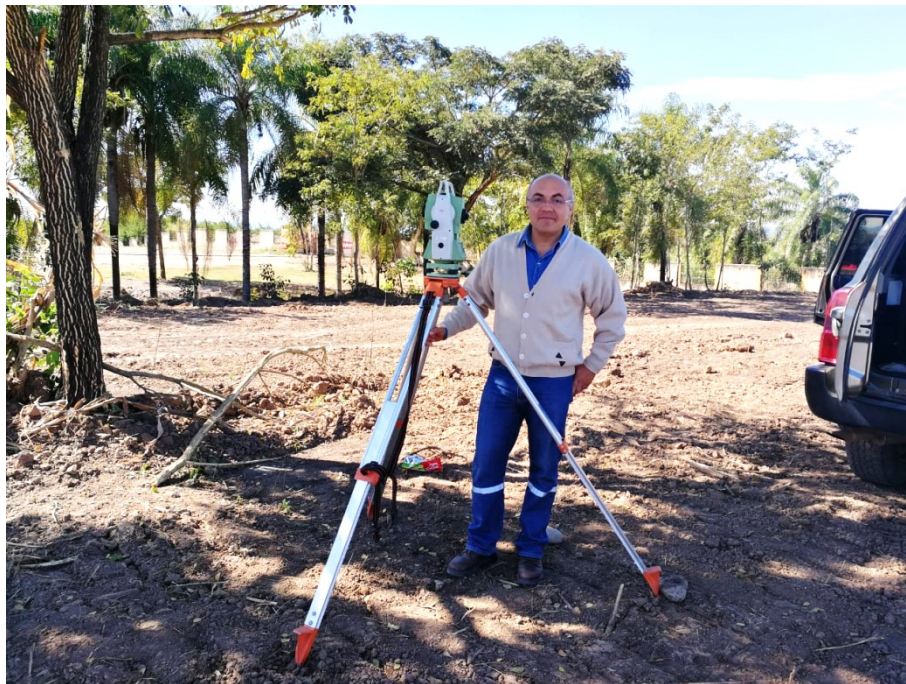
Fotografía. : Levantamiento Topográfico para diseño a accesos internos a Campus Universitario
